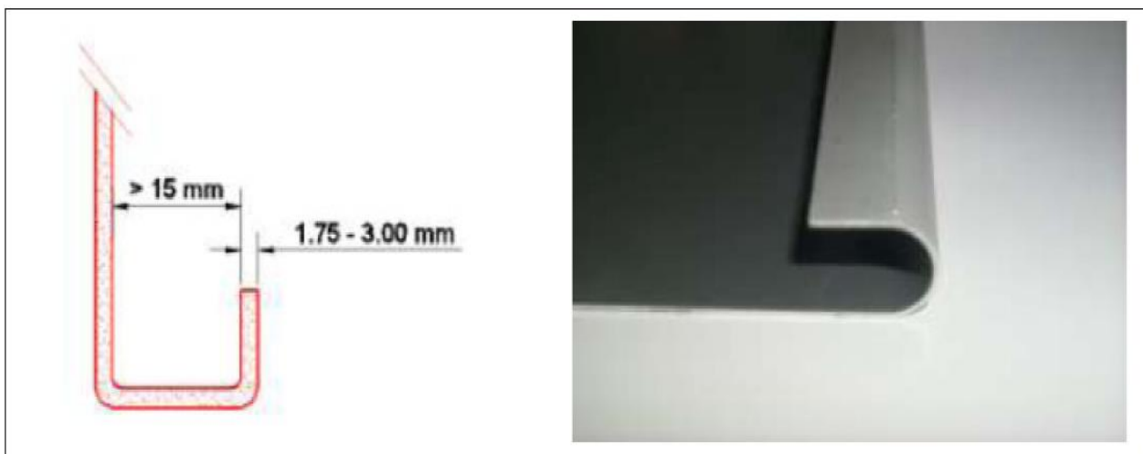
Slika 1. Podloga znaka sa dvostruko savijenim ivicama
