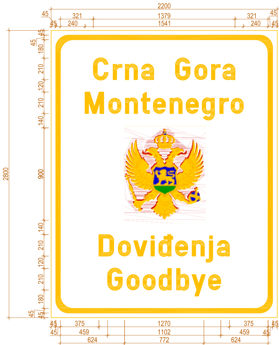
Znak III-13.2 sa anti-graffit folijom dimenzija 2200 x 2800 mm Pismo normalne širine i visine H=210 mm, r=125
