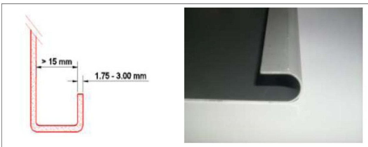
Slika 1. Podloga znaka sa dvostruko savijenim ivicama
