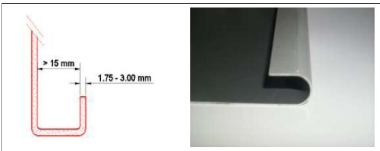
Slika 1. Podloga znaka sa dvostruko savijenim ivicama
