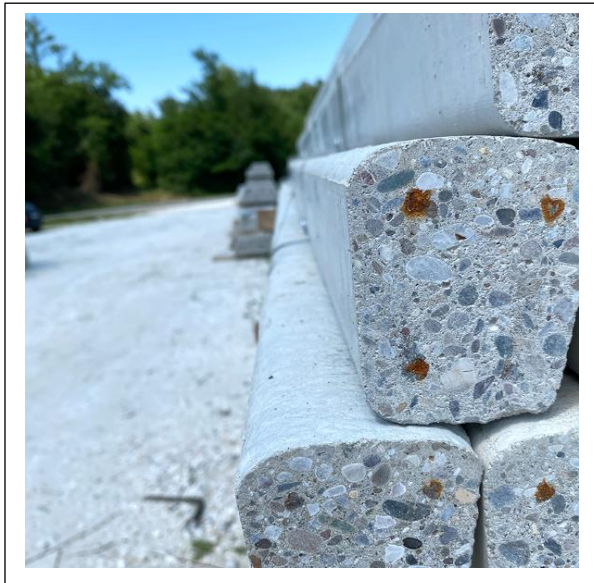
Slika P2-2 -Betonski stubovi dužine 2.5 m
