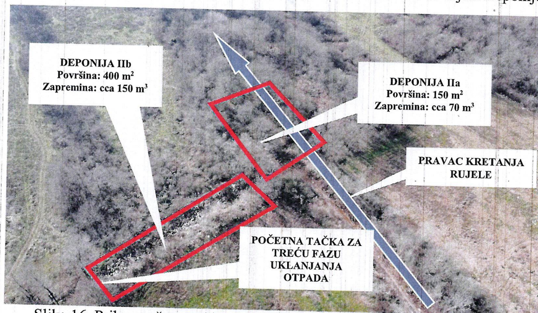
Slika 16. Prikaz početne tačke za radove treće faze (izvor: privatna arhiva)
