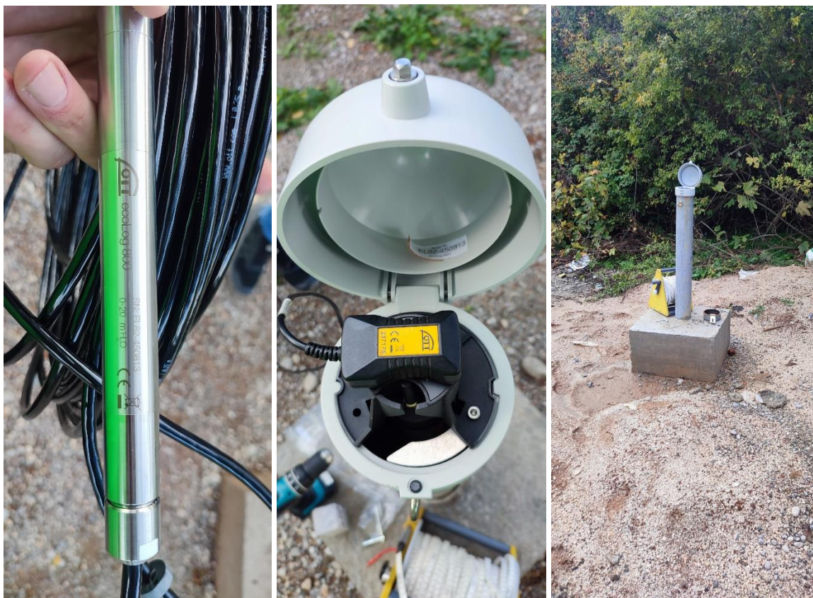
Slika 6. Sofisticirani „ecoLog“ uređaj za kontinuirano praćenje nivoa, temperature i konduktiviteta podzemnih voda
